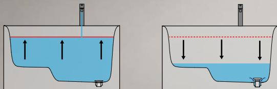
Sistema TROPPOPIENO AUTOMATICO INVISIBILE. La piletta si apre automaticamente al raggiungimento del livello di sicurezza PREDEFINITO, permettendo all'acqua di defluire.
