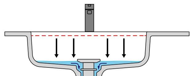
ARENA è il nuovo lavabo con sistema TROPPOPIENO AUTOMATICO INVISIBILE. La piletta si apre automaticamente al raggiungimento del livello di sicurezza PREDEFINITO, permettendo all'acqua di defluire.
