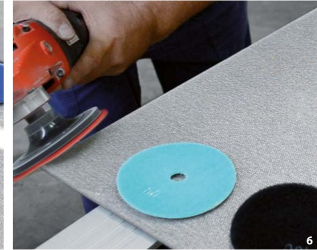
Finitura bordo a secco · Dry edge finishing
