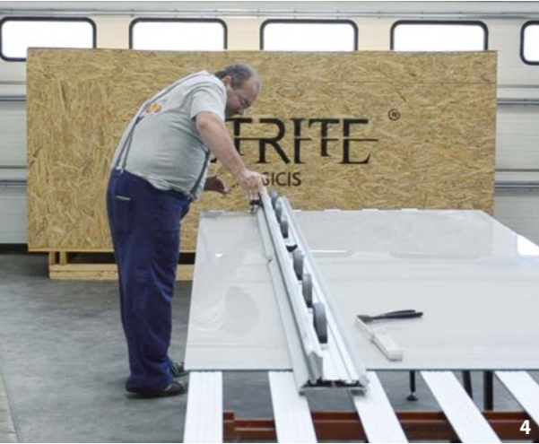
Taglio a secco · Dry cutting
